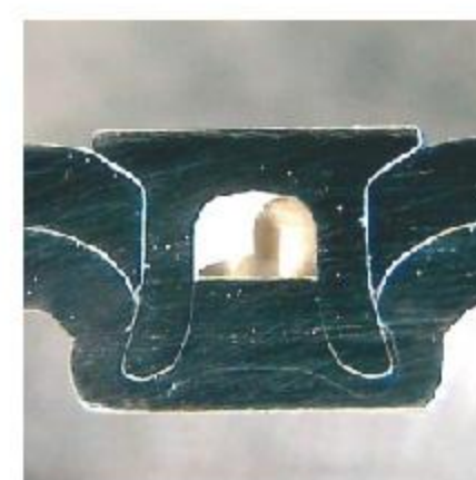
高强度H320:1.2mm 深冲钢DC01:2.0mm
